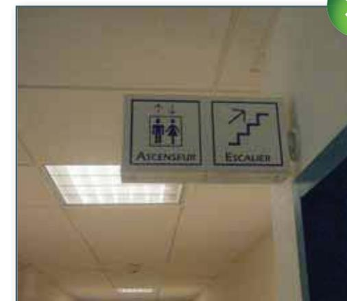
Panneaux suspendus : bord inférieur situé à 2 m 20 minimum du sol afin d'éviter les heurts.
