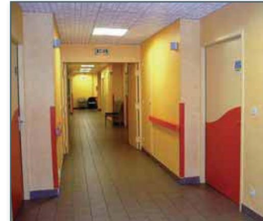
Eclairage direct et permanent par des luminaires carrés avec tubes fluorescents.
